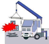
外部からの物体の落下、飛来 接触、倒壊、衝突
